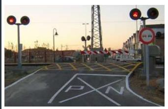
Las señales ópticas a la carretera en pasos a nivel clase "C" dotados de barreras ó semibarreras con funcionalidades de SBA o SBE se sitúan sobre mástil largo independiente ó corto sobre el accionamiento de barrera según las condiciones particulares de cada instalación.
